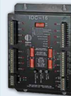
El IOC-16 está diseñado para proveer un gran número de entradas y salidas y para ser monitoreadas y controladas a un NC.
